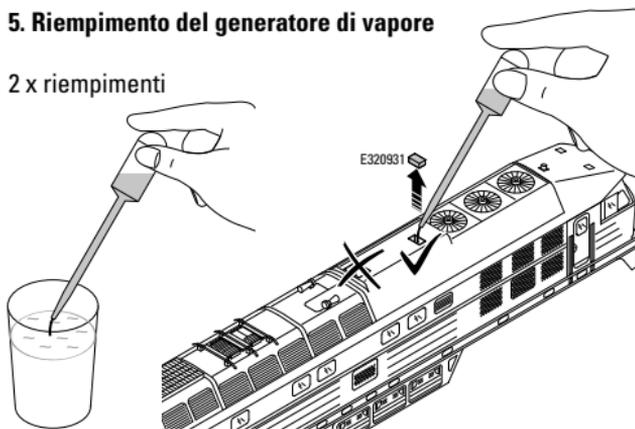
Un riempimento della pipetta produce circa 3 ml.
