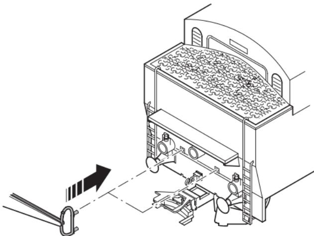
Gehäuse abnehmen • Removing the body
