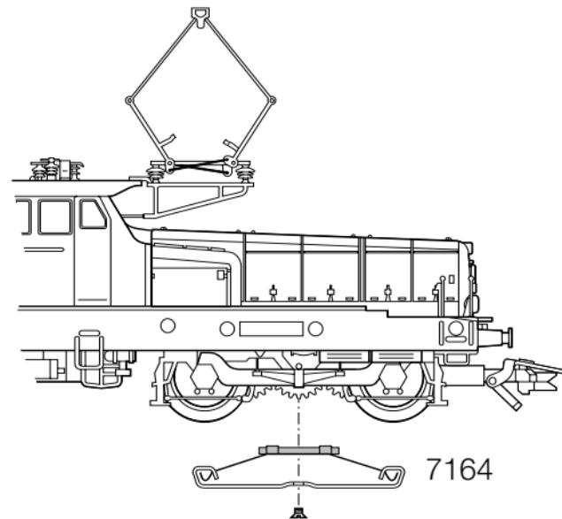
Für Präsentationsmodelle oder bei Betrieb auf großen Radien: Wechsel des Oberleitungs-Schleifers.
