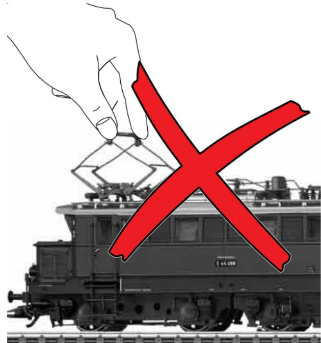
**Hinweis:** Vor dem ersten Betrieb der Lok müssen die Pantographen von Hand entriegelt werden. Der Pantograph federt selbst in die obere Stellung hoch.
