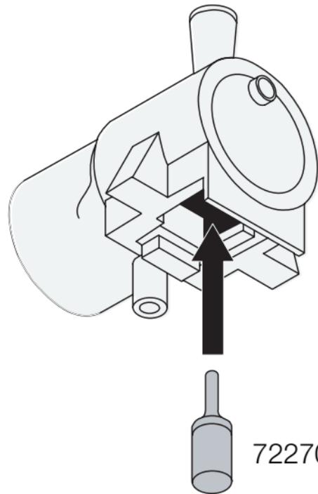
Der Rauchgenerator darf nur maximal halb mit Rauchöl gefüllt sein. Im Rauchgenerator darf sich keine Luftblase befinden.
