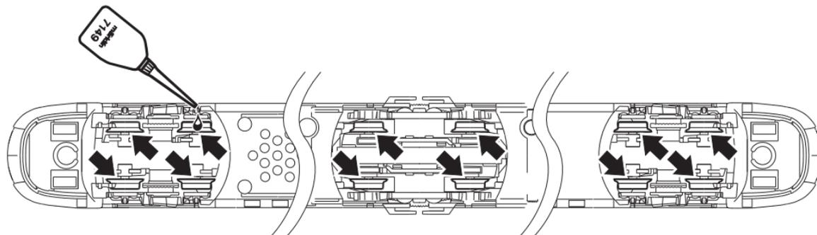
Für den Betrieb dieser Zugeinheit ohne Ergänzungseinheiten den Jumper wie dargestellt einstecken
