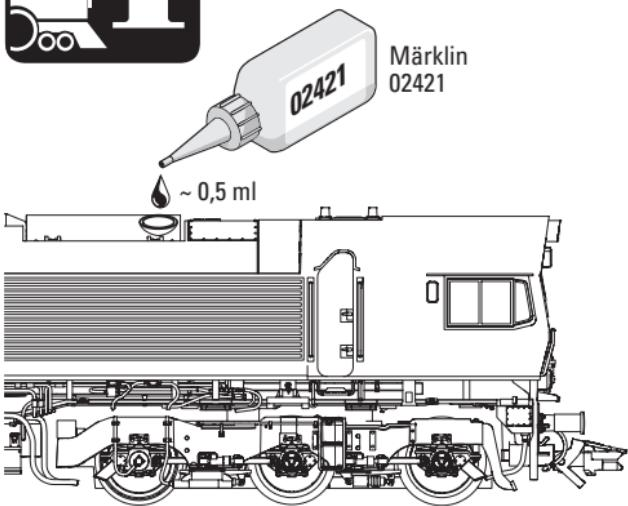
Aus Sicherheitsgründen schaltet der Rauchgenerator nach 5 min ab. Um den Rauchgenerator wieder zu starten muss die Funktion F1 erneut aktiviert werden.
