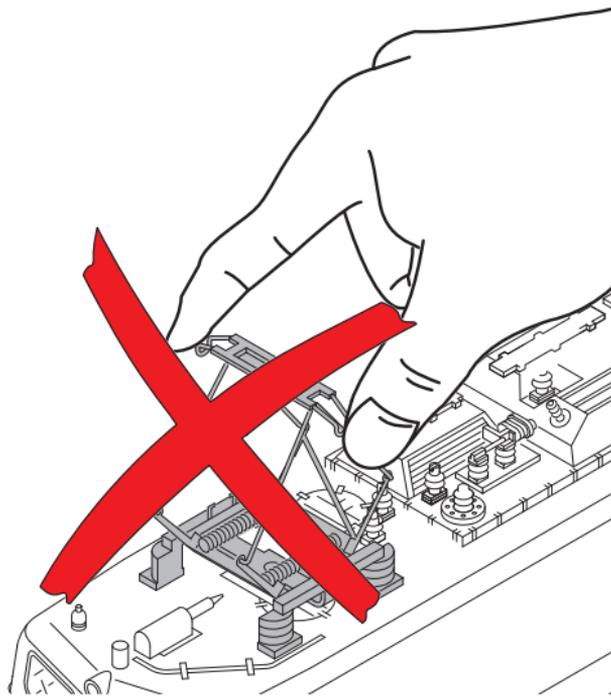
**Hinweis:** Vor dem ersten Betrieb der Lok müssen die Pantographen von Hand entriegelt werden. Der Pantograph federt selbst in die obere Stellung hoch.
