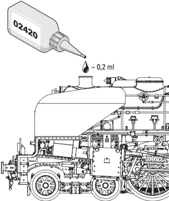
Der Rauchgenerator darf nur maximal halb mit Rauchöl gefüllt sein. Im Rauchgenerator darf sich keine Luftblase befinden.
