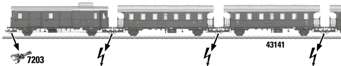
No está permitido enganchar al tender de la locomotora ningún vagón metálico en el cual el enganche esté unido directamente a la masa del carril.
