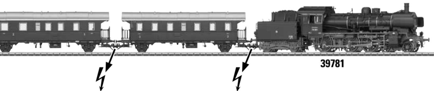
⚡ = stromföhrende Kupplung; current-conducting couplers; Accouplements conducteurs; Spannunggeleidende koppelingen; Conductoresde corriente; Conduttori di corrente; Strömledande kopplarna; Stromforende koblinger
