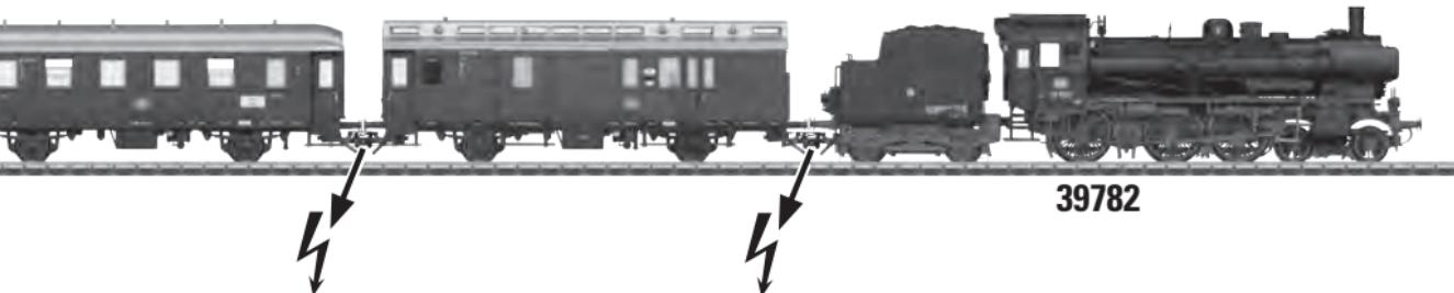
**⚡** = stromführende Kupplung; current-conducting couplers; Accouplements conducteurs; Spanninggeleidende koppelingen;
