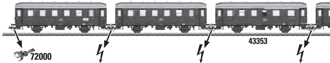
No está permitido enganchar al ténder de la locomotora ningún vagón metálico en el cual el enganche esté unido directamente a la masa del carril.
