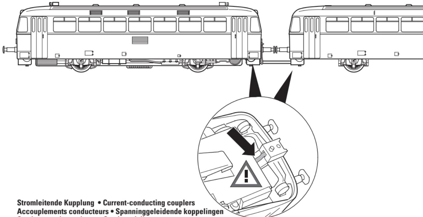
**Stromleitende Kupplung • Current-conducting couplers
