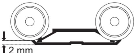
Für Präsentationsmodelle oder bei Betrieb auf großen Radien: Wechsel des Oberleitungs-Schleifers.
